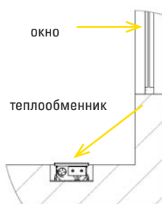
Рис. 3: Конвектор с теплообменником, установленным по направлению «к окну», как дополнительный источник тепловой энергии.
