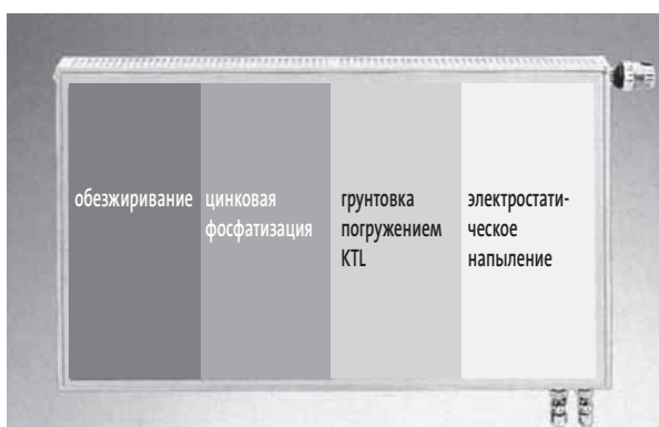
Подготовка поверхности радиатора
