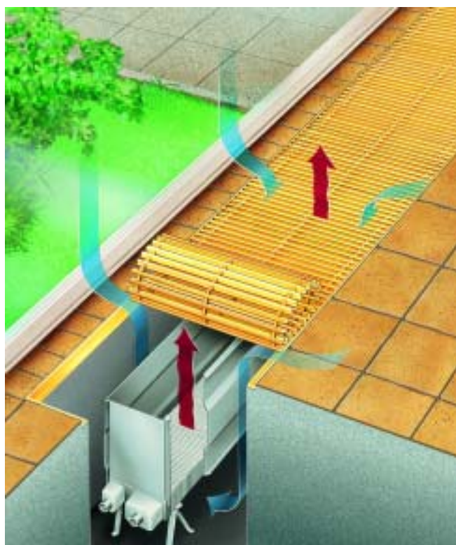
Конвектор Kamrapp, установленный на S-образных консолях в бетонном канале и оснащенный направляющими перегородками и роллонной решеткой.
