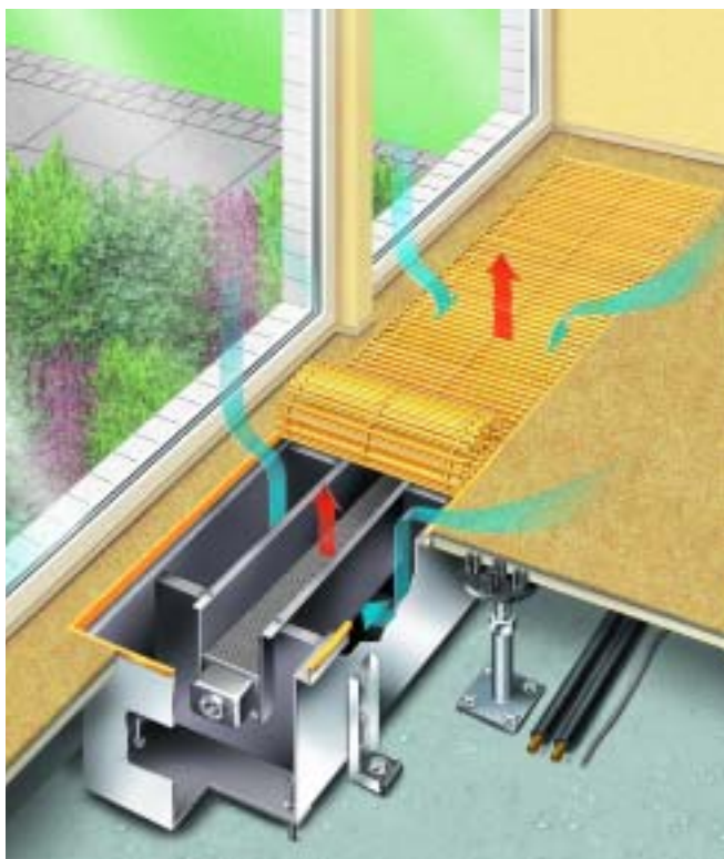
Конвектор Kamrapp, установленный в отопительном канале и закрытый роллонной решеткой
