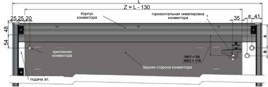
крепление конвекторов NK1, NK2
