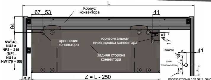
крепление конвекторов NP, NU, NW
